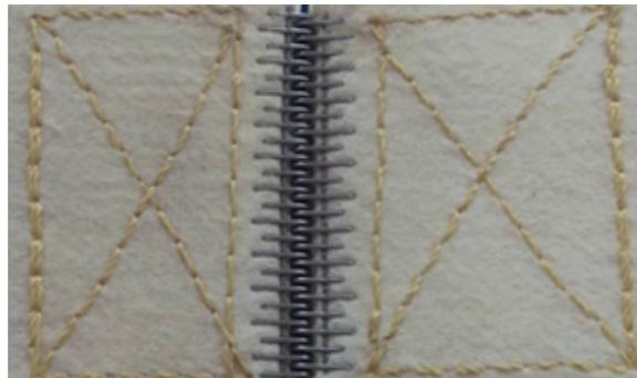
Afin d'éviter la déviation de la courroie, il est possible d'y appliquer **un guide V en PU** ou **une chaîne en métal** en dessous de la courroie. En revanche, cette dernière est une méthode de guidage ancienne et il y a un risque de contact entre la chaîne et le profilé. Contactez-nous pour plus de détails.
